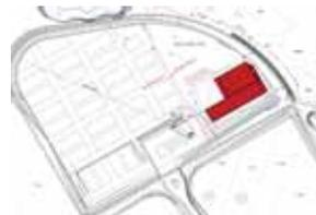
Die Baugrenze der Parzelle wird in einem Teilbereich von ca. 50 m<sup>2</sup> durch die befestigte Freifläche überschritten. Der Grund hierfür ist die notwendige Gebäudeumfahrung von 4 Meter für Feuerwehrfahrzeuge. Zur Kompensation wurde an anderer Stelle die Baugrenze weiter in die Parzelle hineingelegt, um die überschrittene Fläche auszugleichen.
